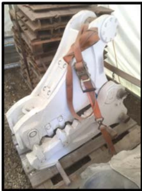
FR-Gebiss (Pulverisierer) zu MK-15 Eigengewicht ca. 680 kg Öffnungsweite Gebiss ca. 740 mm Max. Brechkraft 190 to
