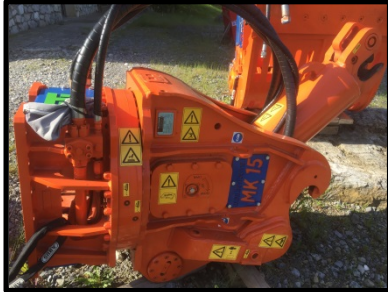
MK 15 Grundgerät - Baggerdienstgewicht von 17 - 27 to Eigengewicht ca. 1180 kg Inkl. Hydraulikschlauchsatz (ohne Kupplungen)
