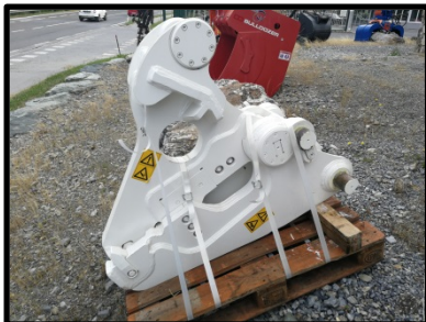
CB-Gebiss (Universalzange) zu MK-15 Eigengewicht ca. 720 kg Öffnungsweite Gebiss ca. 740 mm Max. Brechkraft 420 to
